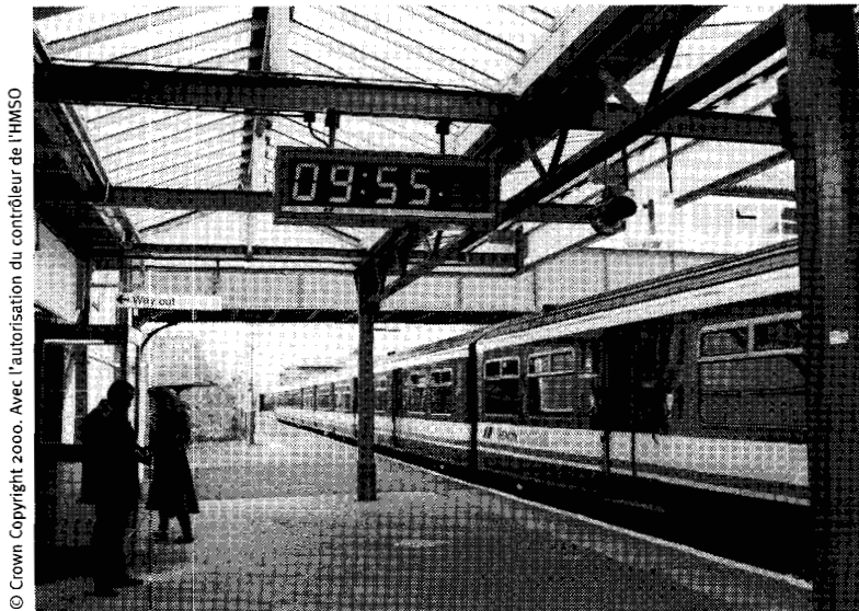
59. Les horloges de gare telles que celle-ci sont contrôlées directement par les signaux radio transmis par l'émetteur MSF.
