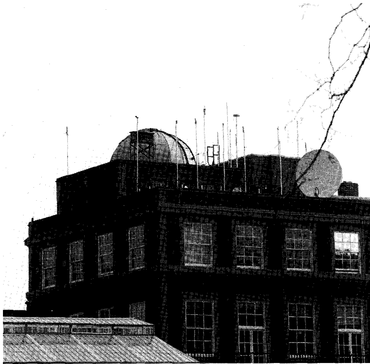
53. Une forêt de récepteurs en cours de test sur le toit du laboratoire de transfert du temps du NPL. La parabole de droite sert au transfert de temps par aller-retour avec des satellites de communication géostationnaires.
