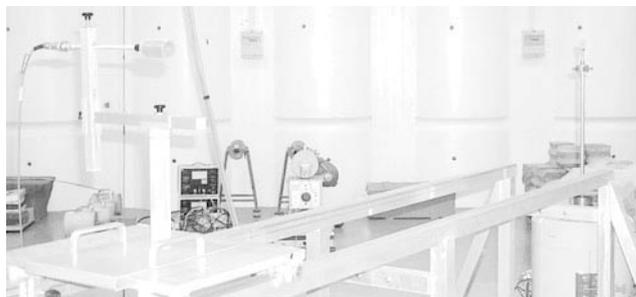
Figure 3.39 – Banc d'étalonnage d'un laboratoire secondaire, lors d'une opération de raccordement pour la mesure du kerma dans l'air avec un chambre de type PTW et une source ponctuelle.
