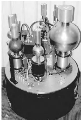
Figure 2.52 – Visualisation des six compteurs proportionnels du ROSPEC.
