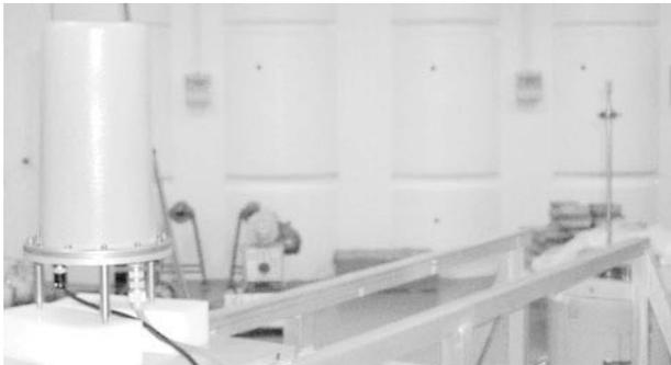
Figure 3.40 – Étalonage de l'appareil de radioprotection sur le banc d'étalonnage, ici une balise  $\gamma$  pour la dosimétrie d'ambiance dans un laboratoire secondaire.
