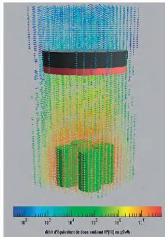
Figure 6.20 – Représentation 3D d'un résultat d'un calcul d'équivalent de dose ambiant dans un maillage, à partir de l'estimateur fluence au moyen de MCNPX 2.6.0 [3].
