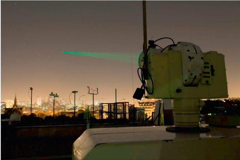
**FIGURE 6.5.** Faisceau laser tiré du laboratoire SYRTE à l'Observatoire de Paris en direction du satellite JASON. Photographie de Pascal Blondet.
