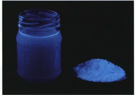
Fig. 22 Principe de l'utilisation d'un azurant optique pour donner l'impression d'un blanc lumineux. La photographie montre la fluorescence de lessives commerciales (liquide et poudre) sous une lampe UV.
