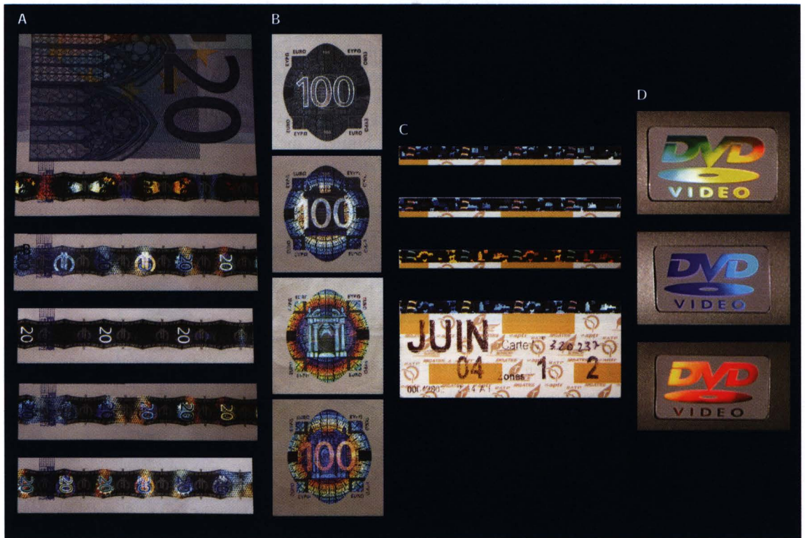
Fig. 11 Couleurs interférentielles de multicouches observées sous divers angles d'illumination : bandes métallisées iridescentes d'un billet de 20 € (A) ; pastille d'un billet de 100 € (B) ; coupon de carte orange RATP (C), icône d'un lecteur de DVD (D).
