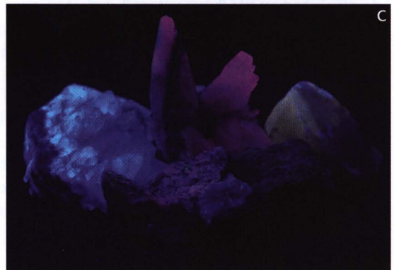
Fig. 7 Divers minéraux éclairés en lumière blanche (A) et par une lampe ultraviolette à vapeur de mercure, dont les raies à 254 nm (B) et 366 nm (C) sont sélectionnées.
