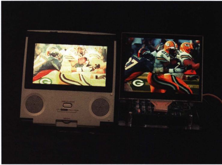
Fig. 13 Comparaison de la luminosité et du contraste entre un écran OLED (à droite) et un écran LCD (cristaux liquides) (à gauche) (cliché Kodak).
