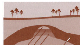
Gaz Pétrole Eau salée Dôme imperméable (argile)
