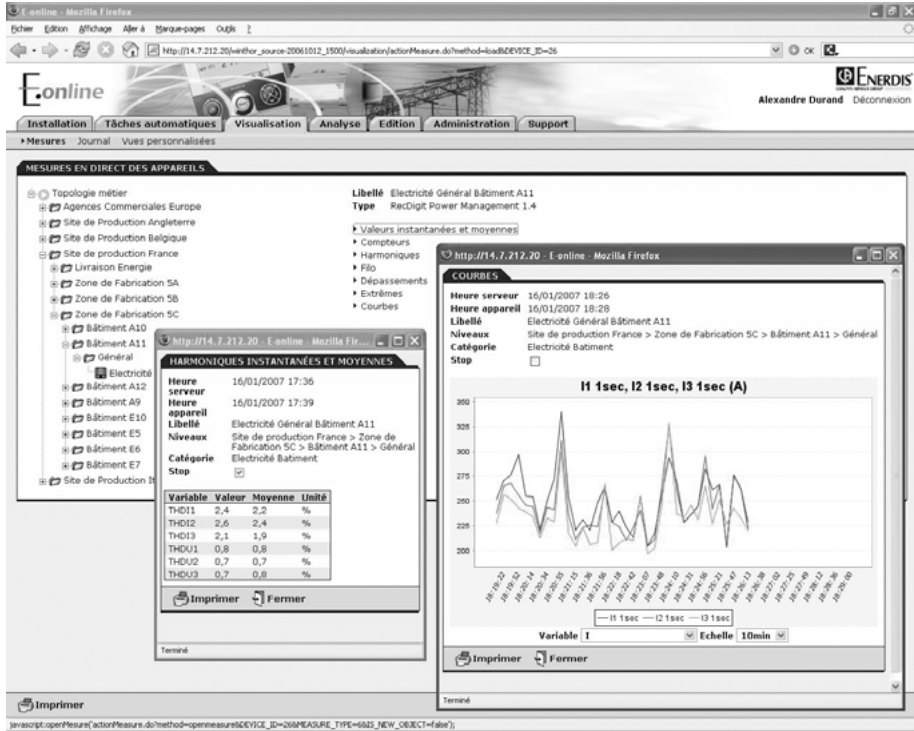
Figure 8.10 – Relevé de grandeurs sensibles telles que les phénomènes harmoniques. © Chauvin Arnoux
