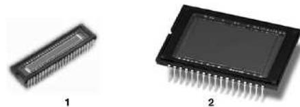
Figure 15.4 Les deux principaux capteurs des images : 1) barrette de capteurs linéaire, 2) matrice de capteurs.
