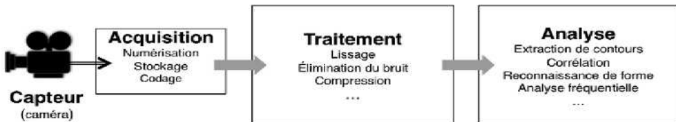
Figure 15.3 La chaîne complète de l'acquisition et du traitement des images.
