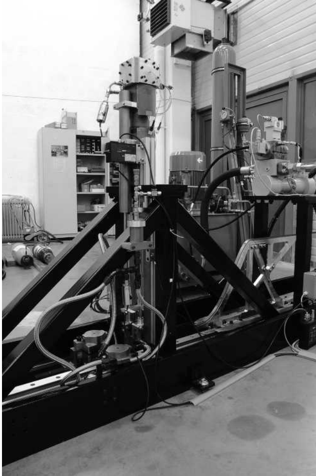
Figure 14.2 La machine à compression rapide : structure mécanique.
