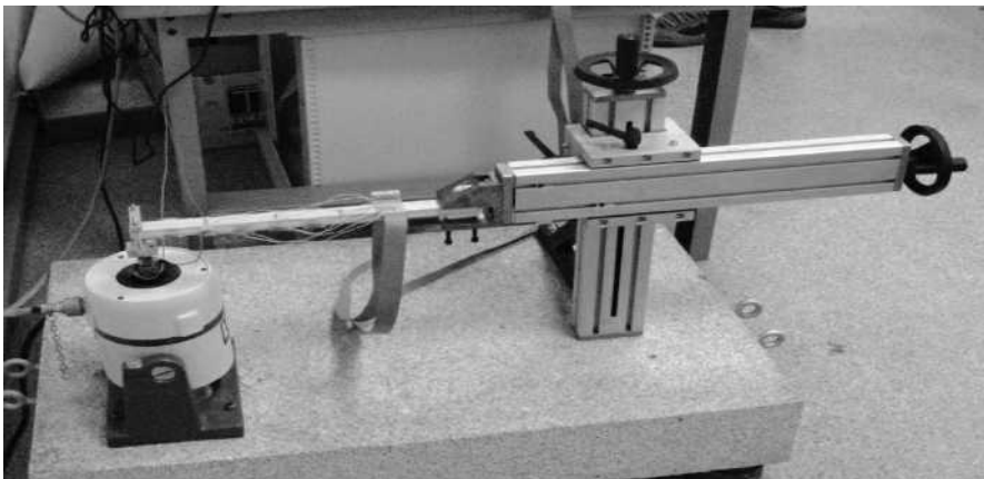
Figure 14.9 Banc expérimental avec le pot vibrant en bas à gauche de la photo.
