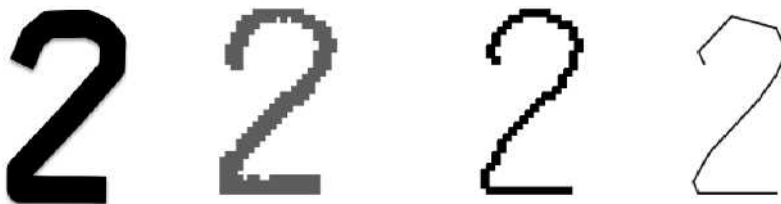
Figure 15.23 Reconnaissance d'une écriture manuelle par squelettisation obtenue par amincissements successifs.
