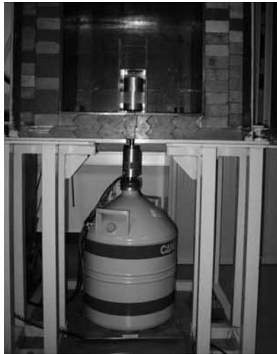
Figure 5.12. Système de spectrométrie \gamma utilisé pour la mesure d'échantillons urinaires constitué d'un détecteur germanium GeHP et d'une enceinte en plomb.
