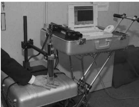
Figure 5.11. Exemple d'appareillage utilisé pour la mesure de plaies (A) et de fantômes d'étalonnages associés (B).
