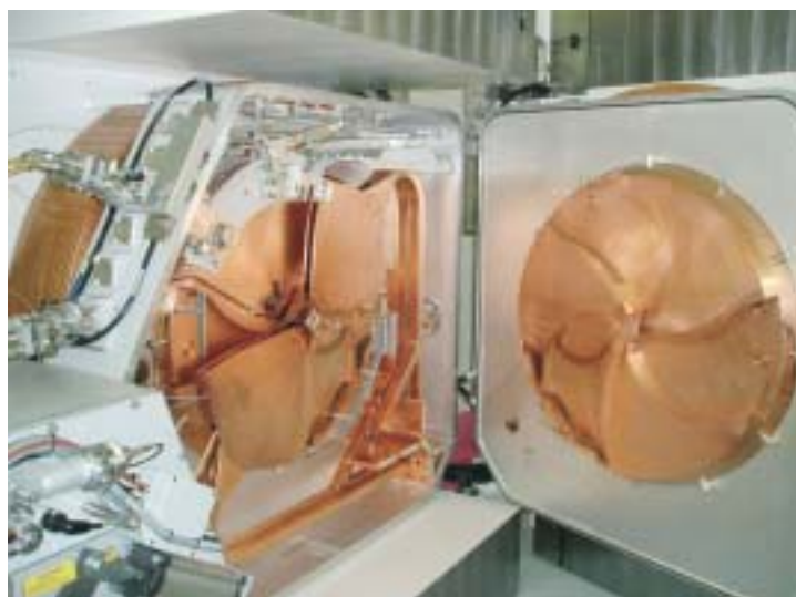
Cyclotron 18 Mev pour la production de Fluor 18. La vue de l'appareil ouvert montre les quadrupoles permettant l'accélération des protons (équipement General Electric).
