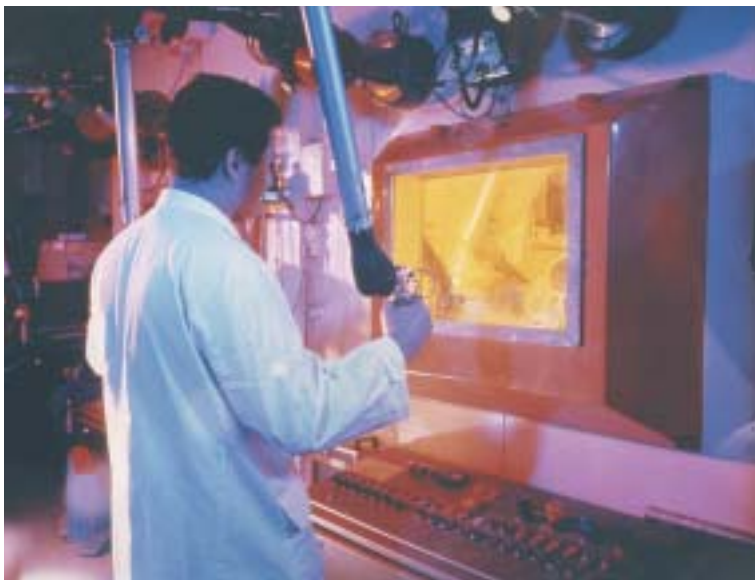
Préparation de radiopharmaceutiques au télémanipulateur derrière d'épais verres au plomb.
