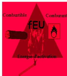
**Lors d'un feu de gaz il est possible d'agir sur le combustible en fermant la vanne d'alimentation.**
