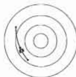
Fig. 10.5 Geodesic on the hot-plate.
