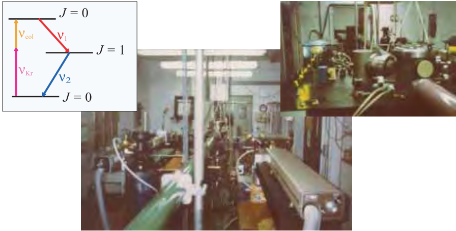
FIG. 2.8 – Expériences d’Orsay (1982) : la source de photons intriqués. On distingue les lasers permettant d’exciter les atomes de Calcium dans le niveau e (par absorption non linéaire des deux photons \nu_{Kr} et \nu_{col} ). Par désexcitation en cascade vers r puis f, l’atome émet la paire de photons intriqués \nu_1 et \nu_2 . Cette source d’une efficacité sans précédent a permis d’effectuer des mesures de corrélation de polarisation avec une précision de 1 % en moins de 2 minutes, autorisant la mise en œuvre de schémas expérimentaux nouveaux de plus en plus proches de l’expérience de pensée. Les photons étaient émis dans des faisceaux opposés, peu divergents, de quelques centimètres de diamètre seulement, ce qui a permis d’éloigner les polariseurs à 6 mètres de la source de photons située dans l’enceinte à vide qu’on distingue au centre de la photo. Avec cette géométrie, un signal se propageant à la vitesse de la lumière mettrait 40 nanosecondes pour aller d’un polariseur à l’autre.
