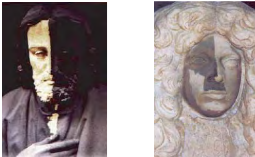
FIG. 4.37 – Illustration des effets de nettoyage de statuaire par ablation laser (THALES Laser).
