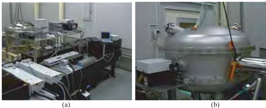
FIG. 4.16 – Source laser Alpha 10 : laser saphir titane délivrant 20 TW (1,2 J en 55 fs à la cadence de 10 Hz) (Thales Laser). (a) L'ensemble du dispositif sur une table optique, (b) cloche sous vide contenant le compresseur d'impulsion.
