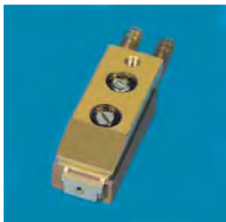
FIG. 4.7 – (a) Puissance émise à 843 \text{ nm} en régime continu (courbe rouge) en fonction du courant avec une barrette de 1 cm de large et une longueur de cavité de 900 \mu\text{m} pour chaque émetteur. Caractéristique V = f (courant d'injection) courbe bleue. (b) Photographie d'une barrette de diodes intégrée dans son embase avec refroidissement. (THALES Research & Technology, THALES Laser Diodes.)
