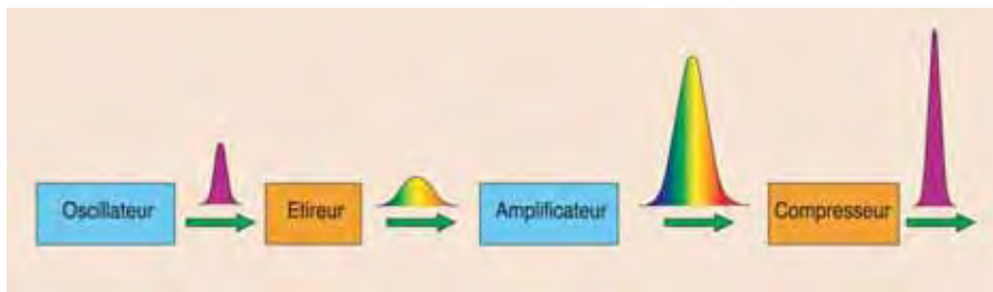
FIG. B.3 – Une impulsion à dérive de fréquence, ultra-courte, issue d'un oscillateur est étirée spectro-temporellement afin de réduire l'intensité optique. Cela revient à répartir l'énergie de l'impulsion dans le temps, donc à réduire la puissance crête. Elle est ensuite amplifiée puis elle est comprimée temporellement.
