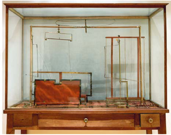
Figure III.10. Le montage expérimental d'Ampère pour la mesure des forces entre les courants (photo Patrick Imbert, Collège de France).
