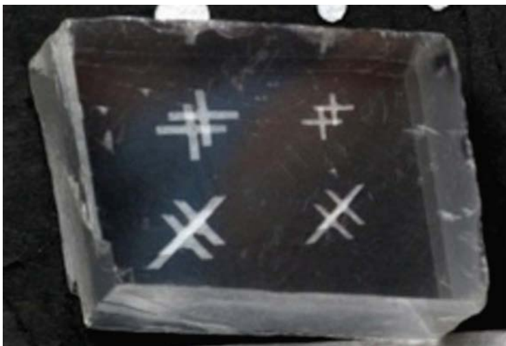
Figure II.8. Double réfraction d'un cristal de spath d'Islande : chacune des croix dessinées sur la feuille noire donne en transmission deux images polarisées à angle droit.
